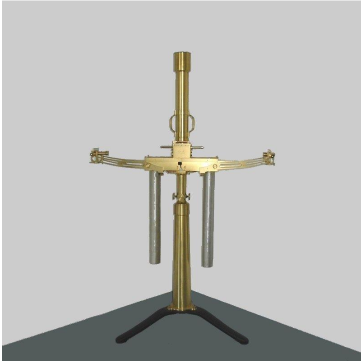
A Miskolci Egyetem Geofizikai Tanszékén helyet kapott kettős inga
